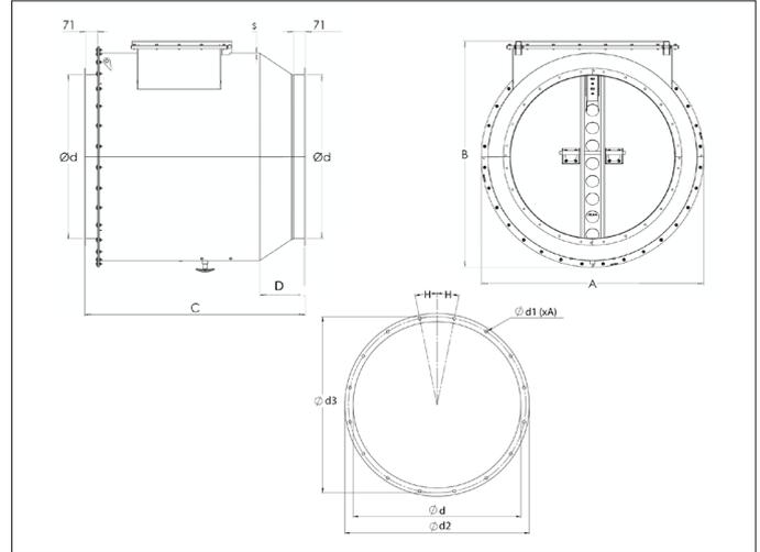
**BADA - Zertifizierte ATEX - Rückschlagklappe**
