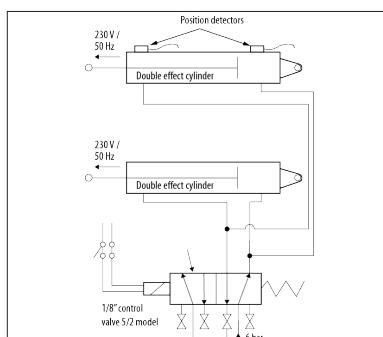
Anschluss von zwei linearen pneumatischen Zylindern für den pneumatischen Schieber ab Durchmesser Ø 203 oder für Spezialausführungen.
