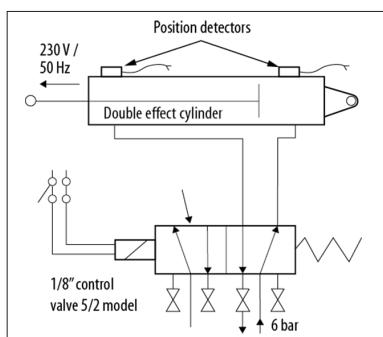
Anschluss eines linear pneumatischen Zylinders für pneumatische Schieber von Durchmesser Ø 50 bis Ø 152.
