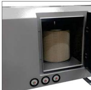
Zugangstüren an der Vorderseite der Einheiten erleichtern die Wartung der verschiedenen Filterelemente.
