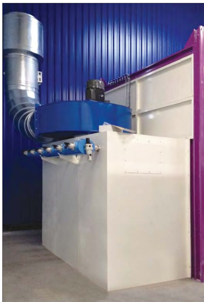
Zuigwand met ventilator gemonteerd, volledig geïntegreerd in spuitcabine
