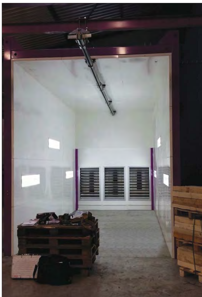
Uitzicht vanaf de binnenkant van de spuitcabine met de geïntegreerde muur
