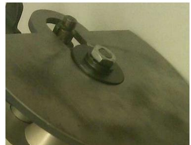
Schritt 3 : Setzen Sie das obere Walze auf die verstellbare Spindel und ziehen Sie die Mutter mit dem Schraubenschlüssel fest. Es ist das Walze mit der schmaleren Breitseite :
