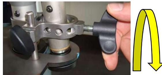
Schritt 6 : Aktivieren Sie die tragbare Kantenmaschine und drehen Sie das Rohr um 360° :
