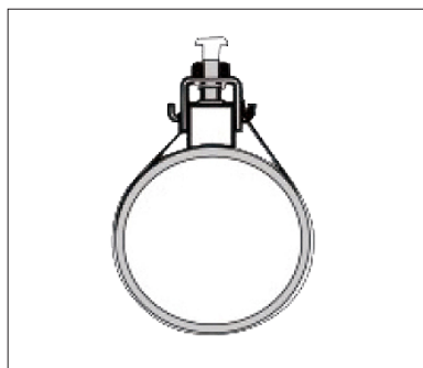
Positionsdetektor mit Spannband zur Befestigung am Zylinder
