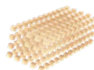
Kleinholz, in Würfel von 1 cm gesägt, Brandfläche 5.4 m 2
