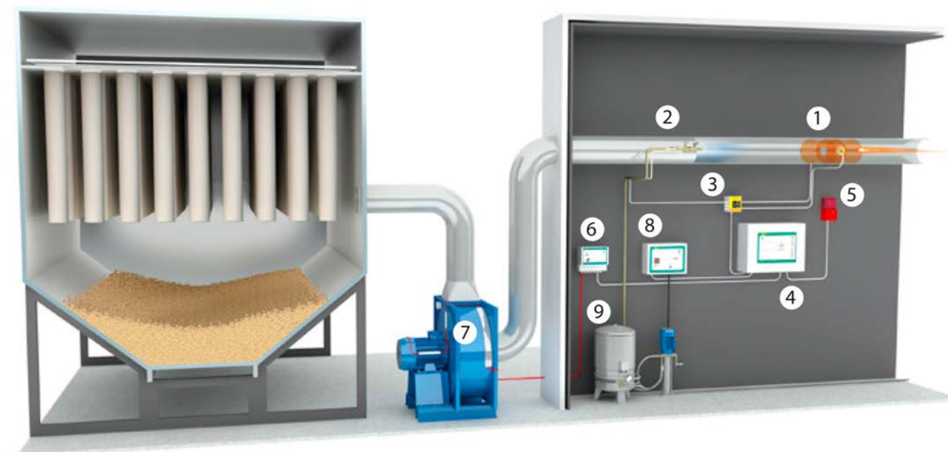
Montageprinzip des Atexon®-Funkendetektions- und Feuerlöschsystems
