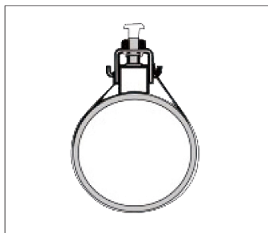
Positiesensor geleverd met riem voor bevestiging aan cilinder
