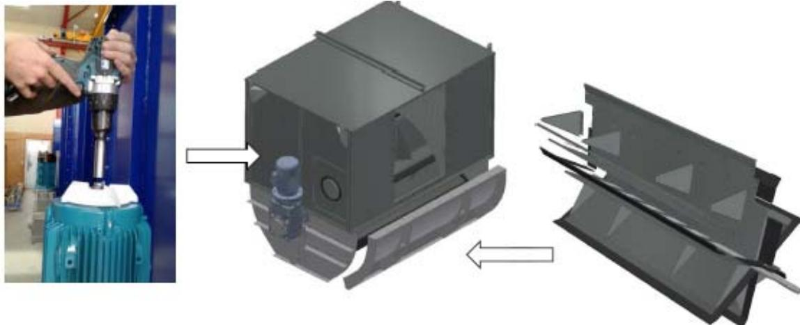
Om de rotor te draaien, demonteert u de ventilatorbehuizing op de motor. Dit geeft toegang tot een bout aan het uiteinde van de motoras die kan worden gedraaid met een sleutel of een niet-slagschroevendraaier.
