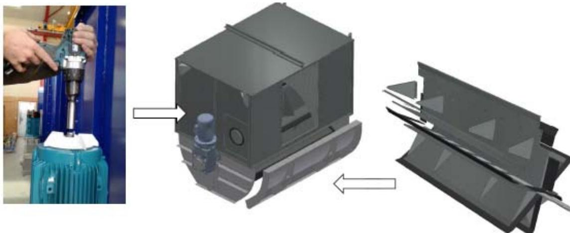
Pour faire tourner le rotor, démontez le carénage du ventilateur sur le moteur. Cela donnera accès à un boulon à l'extrémité de l'arbre du moteur qui peut être tourné à l'aide d'une clé ou d'un tournevis sans impact.
