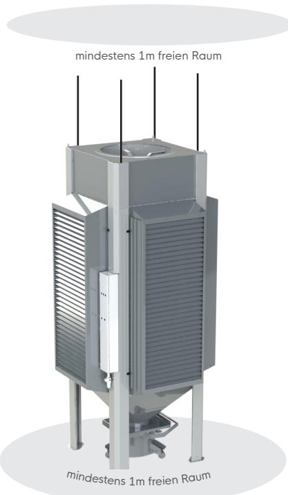
Abbildung 4.1: Erforderlicher Freiraum um das Gerät herum
