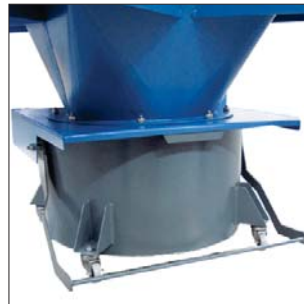
Trechter is afgewerkt met ø400 mm systeemflens. Standaard stofemmer 72 L met 4 draaibare wielen.
