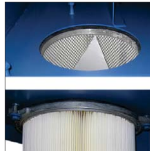
Een filterwissel kan eenvoudig en stofvrij gedaan worden door bayonet flens op de filterpatronen. Losmaken gebeurt vanaf de schone luchtzijde.
