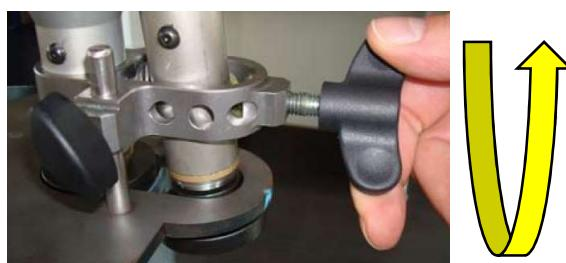
Étape 5 : Glissez le bord du tuyau entre les deux galets, avec la batterie vers l'intérieur du tuyau, et tournez la vis papillon supérieure afin de coincer le tuyau entre les deux galets :
