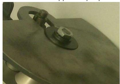
Étape 3 : Placez le galet supérieur sur la broche ajustable et serrez l'écrou avec la clef. C'est le galet avec la partie supérieure plus fine :
