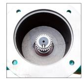
**Engrenage**En acier de haute qualité et roulements NSK.
