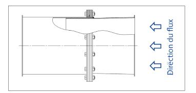
Pensez au sense du flux d'air à l'installation.
